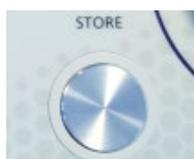
Il pulsante di memorizzazione si trova a sinistra della manopola di controllo del canale 2 (attenuatore). Il pulsante è conduttivo, toccandolo il livello di test e la frequenza attuali saranno memorizzati nella memoria temporanea del dispositivo.
