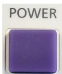
Selezionare il pulsante POWER per 1 secondo per accendere lo strumento. Il display mostrerà brevemente il modello e il tipo di cuffia attualmente selezionato per l'uso. Non è richiesto alcun tempo di riscaldamento, anche se una breve routine diagnostica verrà eseguita per alcuni secondi.
