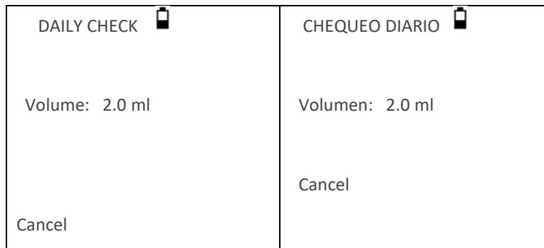
Quitar la sonda y repetir la prueba con las tres cavidades de ensayo restantes. La pantalla debe mostrar el volumen de las cavidades de 0,2 ml y 0,5 ml de prueba de  $\pm 0,1$  ml. La cavidad de ensayo 5,0 ml debe estar dentro de  $\pm 0,25$  ml.
