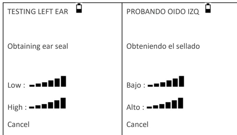
Cuantas más barras se muestren, más calidad tendrá el sellado del oído. La sonda debe ajustarse en el oído hasta que se muestren dos o más barras para Low (Baja) y High (Alto).
