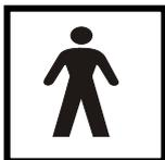
**Definizione:** Parte applicata di tipo BF - una parte applicata che fornisce un grado di protezione contro le scosse elettriche superiore a quello fornito da una parte applicata di tipo B, in particolare per quanto riguarda la corrente di dispersione ammissibile del paziente e la corrente ausiliaria del paziente.
