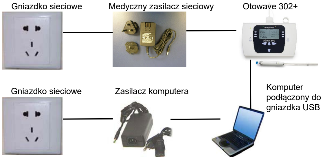
Schemat 3: Urządzenie Otowave 302+ podłączone do zasilacza dopuszczonego do zastosowań medycznych oraz komputera
