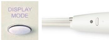
Pour afficher les paramètres de test actuellement sélectionnés, assurez-vous que le **MENU PRINCIPAL** est affiché, puis appuyez et maintenez enfoncé le bouton de fonction de la sonde pour afficher l'écran **PARAMÈTRES DE TEST** comme indiqué ci-dessous.
